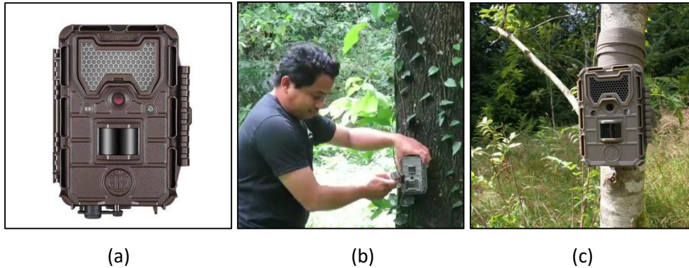
Gambar 4. Metode Camera Trap untuk Mamalia. (A) Jenis Camera Trap yang Digunakan, (B) Cara Pemasangan, (C) Camera Trap yang Sudah Terpasang.
